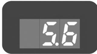
Presione el botón “**+**” para aumentar la temperatura del color o presione el botón “**-**” para disminuirla. Si mantiene presionado cualquiera de los botones, obtendrá una variación continua rápida. Cada vez que presione los botones, aumentará o disminuirá la temperatura del color en incrementos de 100 Kelvin.
